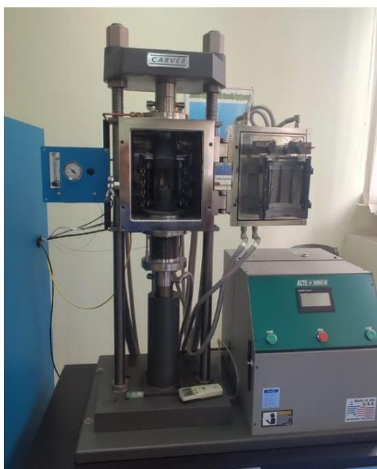
Рисунок 2.3 – Установка для горячего прессования
