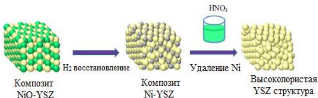
Рисунок 1.7 – Схематическая иллюстрация отдельных стадий метода селективного химического вытравливания
