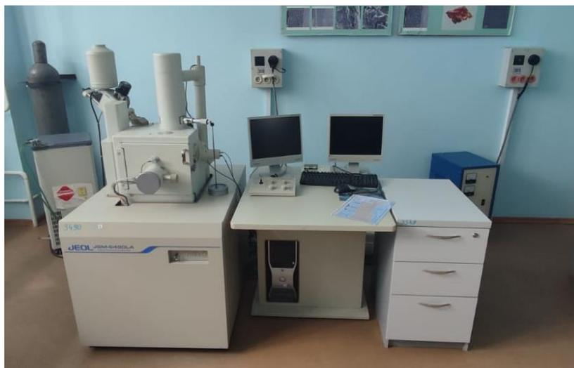
Рисунок 2.8 – Сканирующий электронный микроскоп JEOL JSM-6480LV с высоким разрешением
