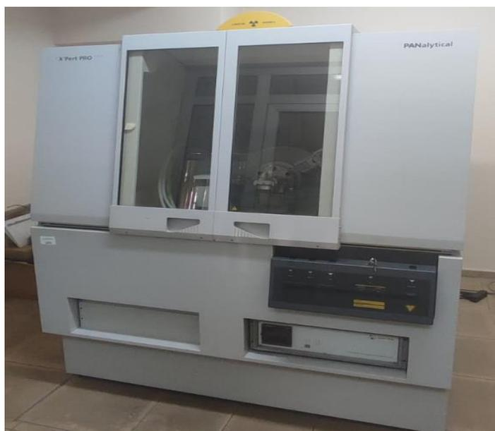
Рисунок 2.10 – Рентгеновский дифрактометр X'Pert MPD PRO (PANalytical)
