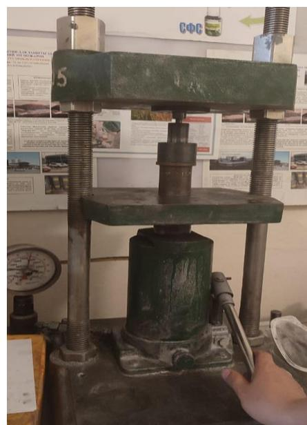
Рисунок 2.5 – Установки для механического смешивания и прессования порошков
