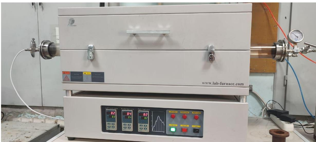
Рисунок 2.6 – Высокотемпературная трехзонная трубчатая печь
